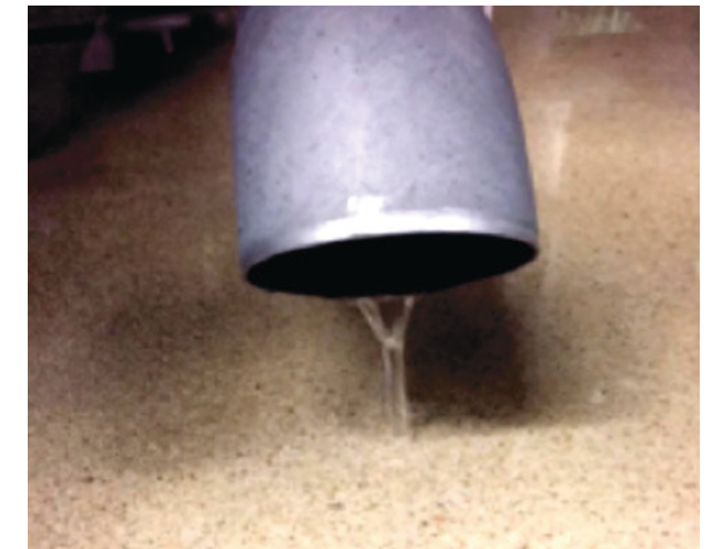
Bild: Mineralwasserentgasung: Vorher 1200 Liter/h @ 11,3 °C nachher 90 Liter/h @ 36 °C
